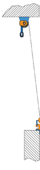
Montajul la un braț cu cârlig (brațul coborât)
